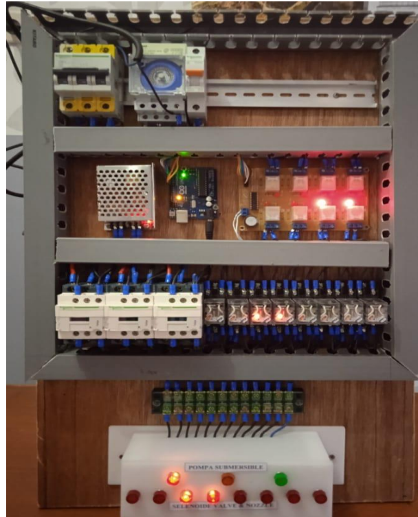
Gambar 4 Perancangan sistem kendali motor listrik 3 phase untuk pola air mancur
