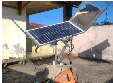
Gambar 3.2 Pengujian sistem integrasi tracking dan reflektor ukuran cermin 40x35 CM sudut 80°, 70°, 60°
