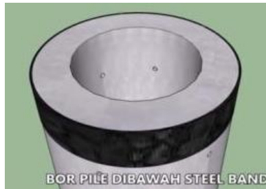
Gambar 4 Pengeboran pada spun pile existing
