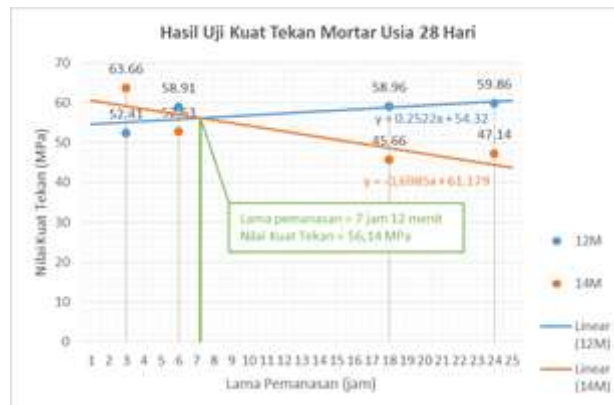
Gambar 5 Grafik trendline hasil uji kuat tekan mortar geopolymer 12 m dan 14 m pada usia 28 hari
