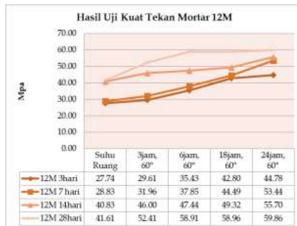
Gambar 3 Grafik Hasil Uji Kuat Tekan mortar geopolimer 12M.
