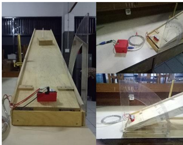
Gambar 4 Prototipe alat menghitung koefisien gesek
