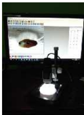
Gambar 4. Pengambilan gambar penampang serat tunggal pelepah salak menggunakan mikroskop digital
