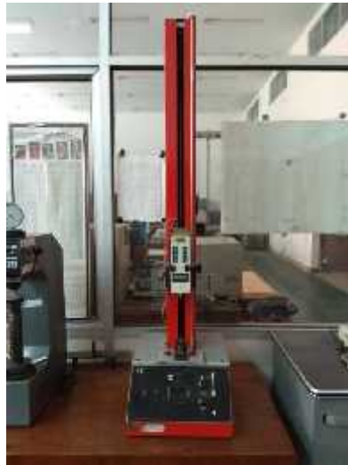
Gambar 3. Mesin uji tarik Parson Panke
