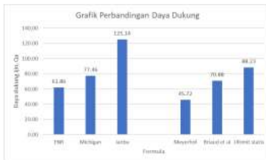
Gambar 3 Grafik perbandingan daya dukung tiang pancang pada P2 Sumber: Hasil perhitungan
