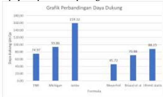
Gambar 2 Grafik perbandingan daya dukung tiang pancang pada P1 Sumber: Hasil perhitungan
