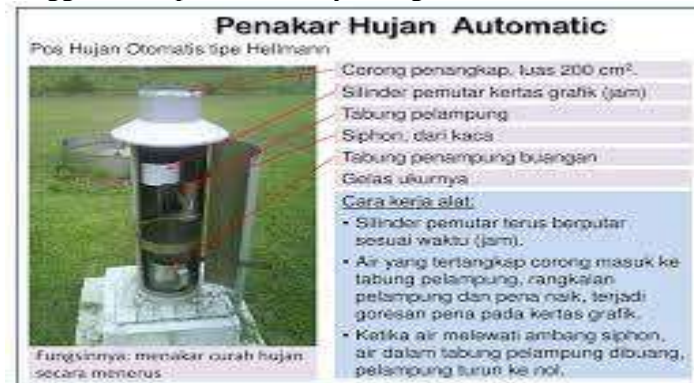
Gambar 5. Peralatan Alat Penduga Tinggi Muka Air dan Penakar Curah Hujan (Kementerian PU, 2012)
