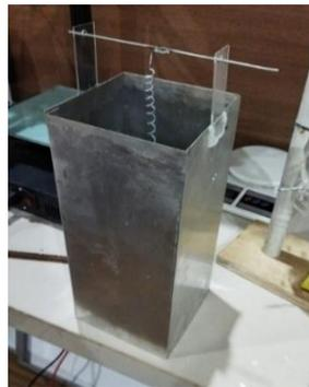
Gambar 4 Prototipe Cerobong Asap Beserta Elektroda dengan Alumunium
